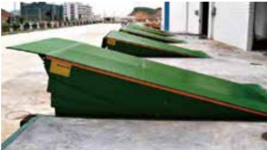
■ 固定登车桥是实现货物快速装卸的专用辅助设备，它的高度调节功能使用货车与库房的货台之间架起一座桥梁，叉车等搬驶及货车内部进行货物的批量装卸，仅需单人作业，即可实现货物的快速装卸，适用于装卸场上各种车辆以及交通相对繁忙的场所。海之力产品配有防溜车装置：该装置是由钢板焊接而成的，可有效地实现防滑的功能，安全可靠。
